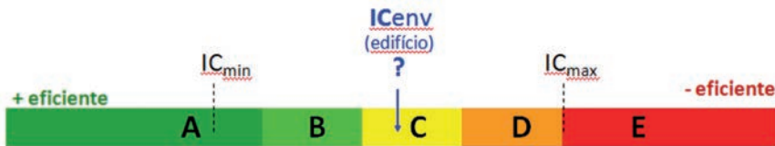
Figura 5 – Intervalos de eficiência a partir do indicador de consumo da envoltória do edifício
