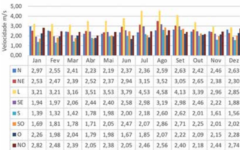
Figura 10: Velocidade média mensal dos ventos (m/s) da série 2001-2013/INMET para Brasília, para cada direção e mês do ano
