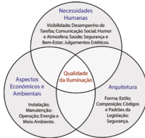
Figura 3: Diagrama que demonstra o modelo de Qualidade da Iluminação para a IESNA
