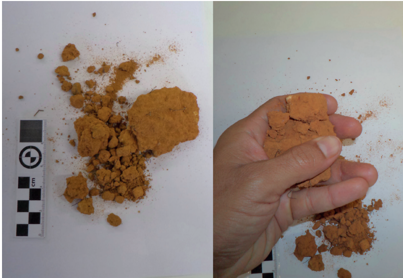
Figura 9.6: Torrões e agregados de solo (esquerda) e trabalho manual para separação de torrão em agregados (direita)
