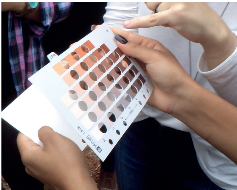
Figura 9.9: Determinação da cor do solo utilizando a Carta de Munsell
