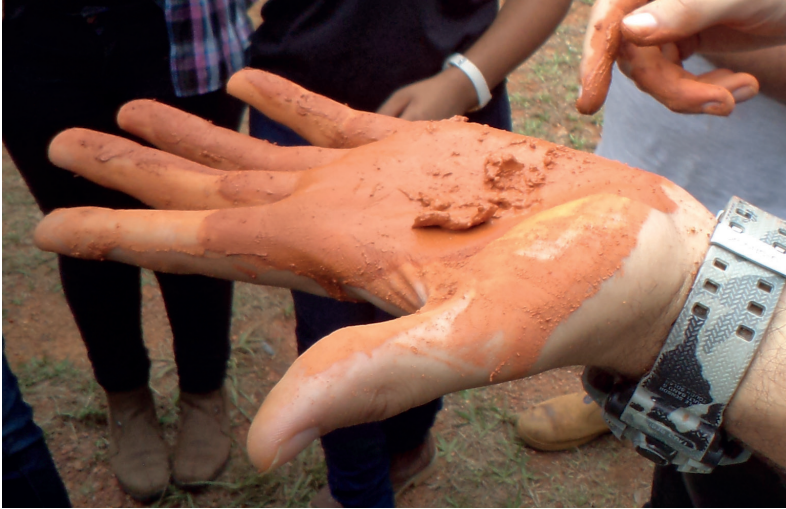
Figura 9.12: Teste de textura do solo a campo
