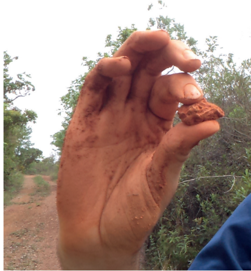
Figura 9.8: Teste de consistência seca ou úmida em agregados de solo
