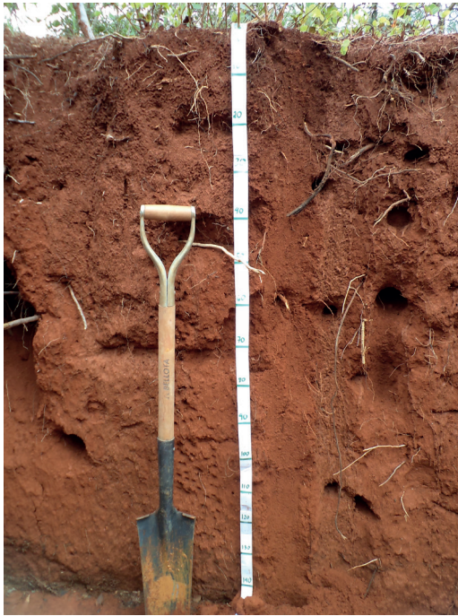
Figura 12.10: Perfil de latossolo vermelho (Brasília-DF)
