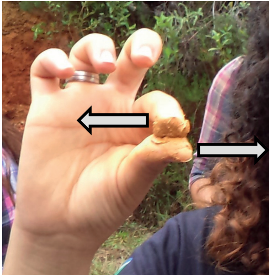
Figura 9.12: Teste de textura do solo a campo
