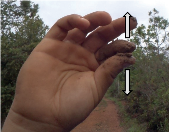
Figura 9.13: Teste de consistência molhada (pegajosidade)
