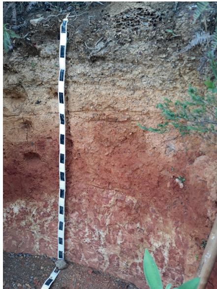
Figura 9.4: Exemplo de utilização de fita para medidas no perfil de solo
