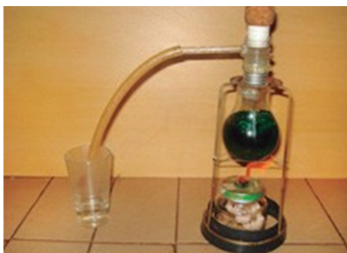
Figura 4: destilador artesanal para separação de misturas
