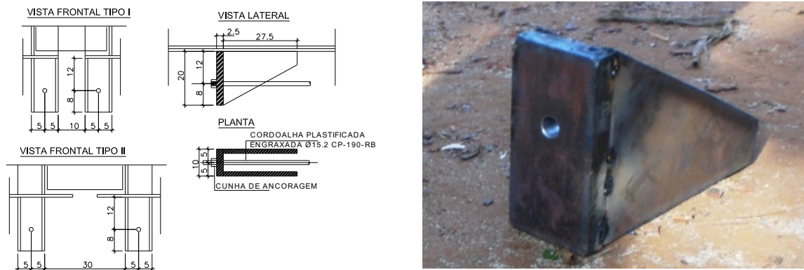
FIGURA 9: DESENHOS DE PROJETO DAS ANCORAGENS E FOTO DE UM ELEMENTO FABRICADO
