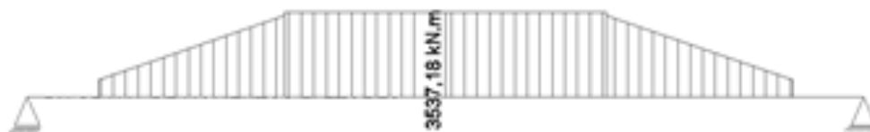
FIGURA 13: DIAGRAMA DE MOMENTOS FLETORES DEVIDO À PROTENSÃO EXTERNA
