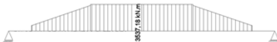
FIGURA 13: DIAGRAMA DE MOMENTOS FLETORES DEVIDO À PROTENSÃO EXTERNA
