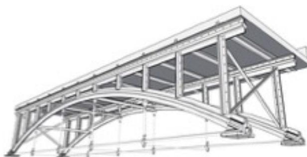
FIGURA 10: VÃO EM ARCO COM 13.5M
