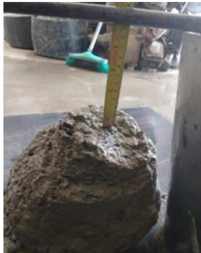
Figura IX - Slump Teste com aditivo superplastificante. Fonte: Própria (2020).
