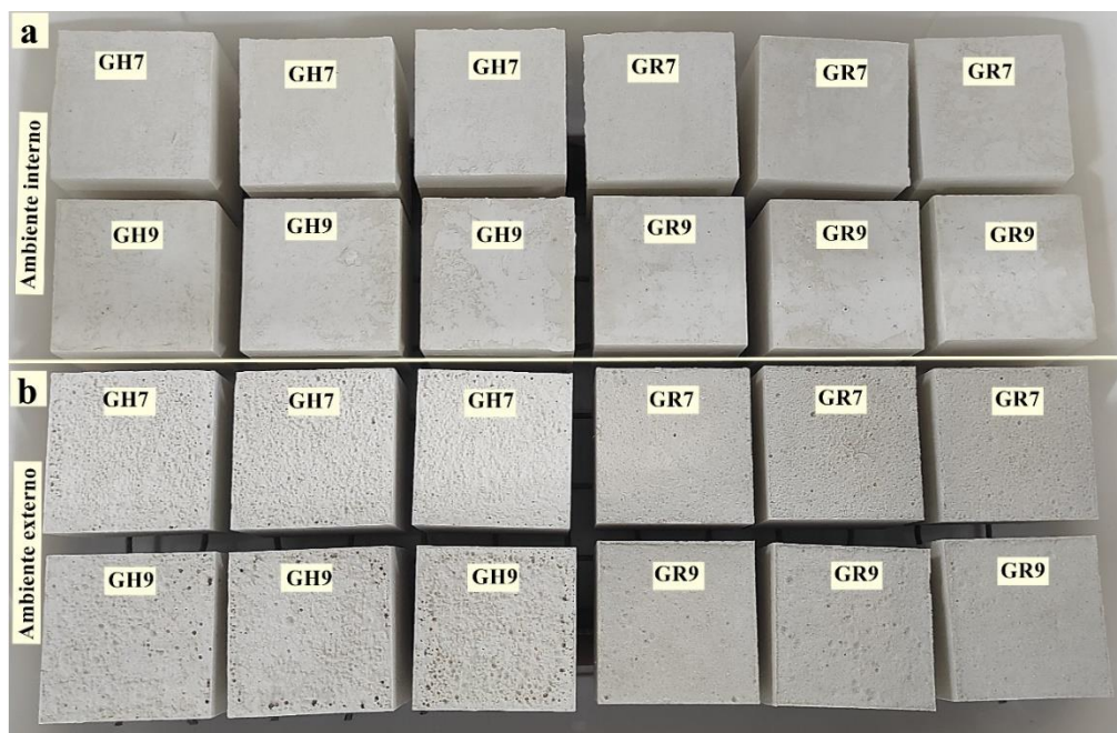
Figura 5 – Corpos de prova após o envelhecimento. a. Corpo de prova submetido ao envelhecimento em ambiente interno. b. Corpo de prova submetido ao envelhecimento em ambiente externo.
