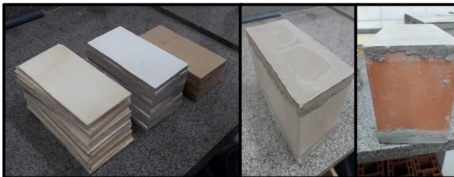
Figura 1 - Capeamentos secos (a) e pasta de cimento utilizados no ensaio (b).
