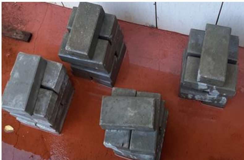
Figura 3 - Blocos de pavimentação desformados.
