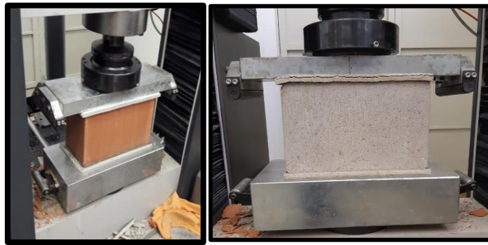
Figura 3 - Ensaio de compressão com capeamento de Forro Pacote nos blocos cerâmico (à esquerda) e de Concreto (à direita).
