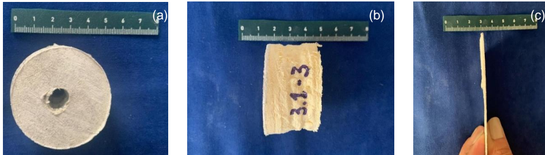
Figura 7 – Amostras de revestimento 1: (a) amostra retirada pela perfuração (direita), (b) vista da amostra de revestimento retirada, (b) incluindo o isolamento aplicado (centro) e (c) lateral (espessura) do revestimento (direita).
