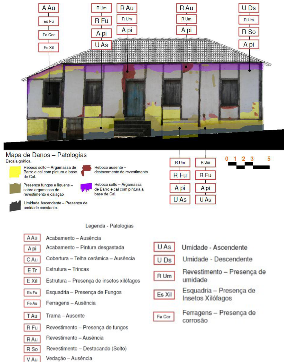
Figura 11 – Exemplo de Mapa de Danos (Parcial) – Construído com as informações obtidas das FID
