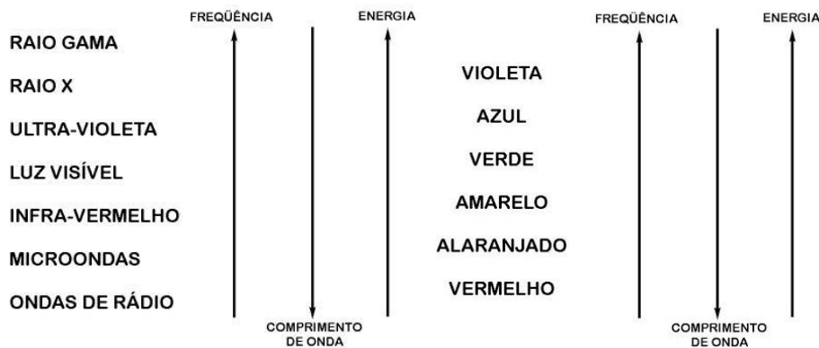
Figura 45 – Esquerda: relação da energia com comprimento de onda e com frequência das diversas faixas do espectro eletromagnético. Direita: a mesma relação, porém associada às subdivisões da luz visível
