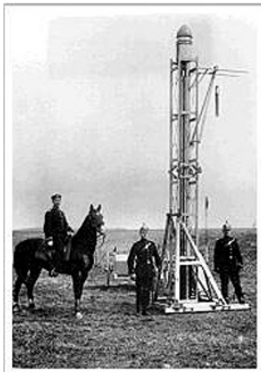
Figura 12 – Foguete de propulsão a ar comprimido de Albert Maul
