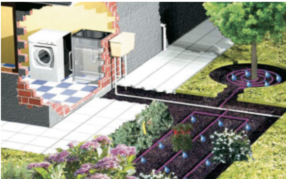
Figura 9 – Sistema de desvio de águas cinzas
