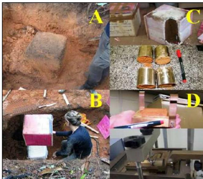
**Figura 6.** Coleta de bloco indeformado in situ e acondicionamento (A e B); Corte do bloco em laboratório para o ensaio de cisalhamento direto inundado e corpos de prova talhados em anéis cilíndricos de metal rígido com 5,0 cm de altura e 5,0 cm de diâmetro interno (C); Corpo talhado de amostra indeformada e amostra devidamente acondicionada em célula de metal para ensaio de cisalhamento direto inundado (D). Fotos: Fabiana Souza Ferreira (Maio, 2012 - Município de Caraguatatuba/SP).
