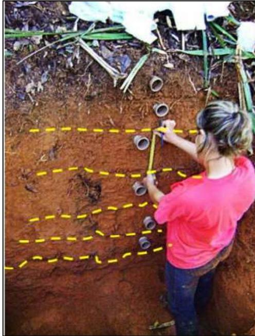
**Figura 5.** Demarcação para coleta de amostras deformadas e indeformadas ao longo de distintas profundidades, conforme são observadas alterações texturais (tátil-visuais) dos grãos de solo, buscando-se melhor descrever as alterações do perfil. Foto: Fabiana Souza Ferreira (maio, 2012 - Município de Caraguatatuba/SP).
