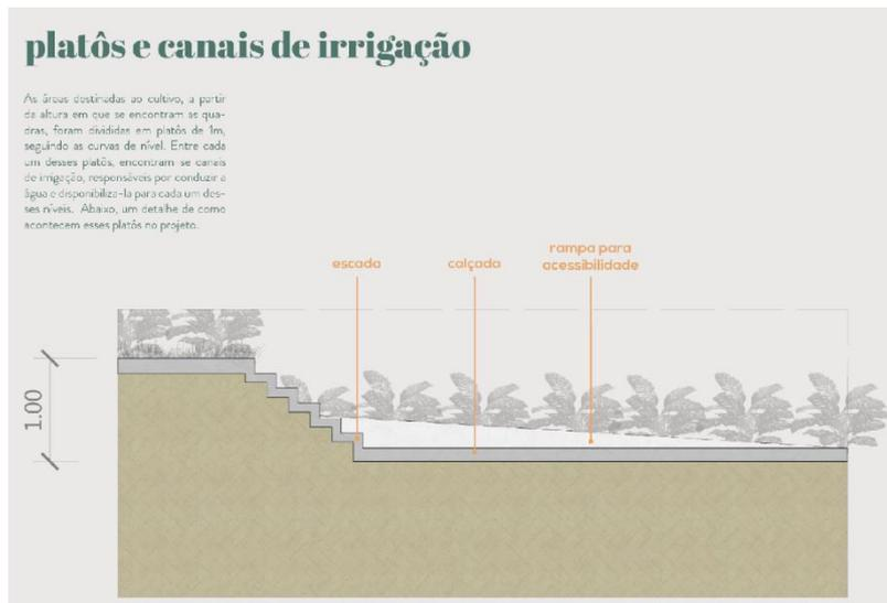
Figura 7. Detalhamento dos canais de irrigação. Fonte: Siqueira (2019).
