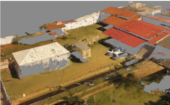
Figura 3.2 – Imageamentos obtidos para voos em uma direção com diferentes coberturas laterais e longitudinais
