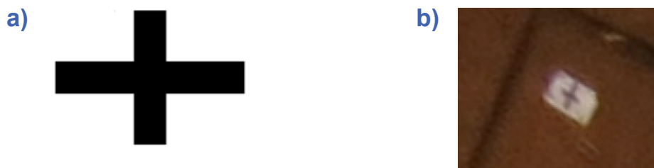
Figura 3.6 – a) tipo de alvo; b) visualização da fotografia com alvo de 4 x 4 pixels , voo a 150 m e GSD de 7,5 cm com câmera S100
