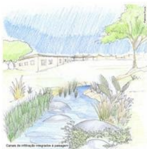
Figura 39 - Canais de infiltração integrados ao desenho dos espaços públicos. Desenho: Patrícia Fiuza.
