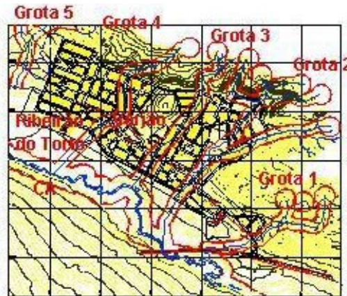
Figura 8 – Projeto urbanístico com as margens das APPs (grotas - limites de 30m) demarcadas. Fonte: Andrade(2005), apud TOPOCART (2003).
