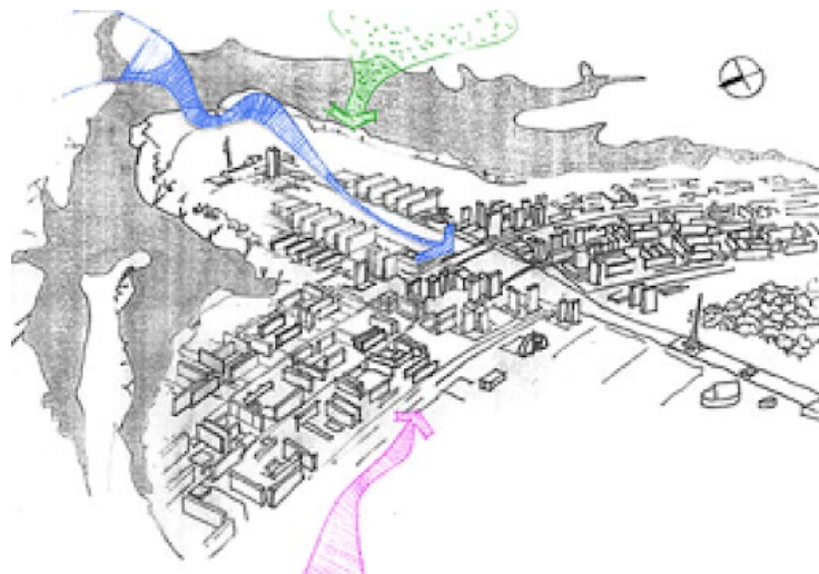
Figura 4 – Ventilação no Plano Piloto de Brasília – DF. Fonte: Da autora.
