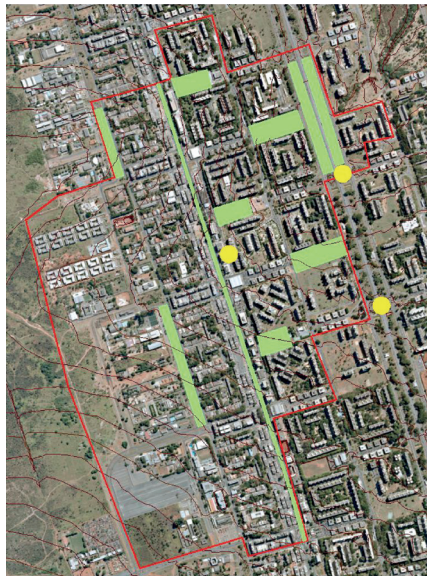
Figura 7: Espaços livres que podem amortecer e reter as águas pluviais
