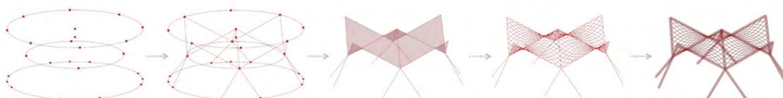
Figura 7: Processo de modelagem da cobertura. Fonte: Autor.
