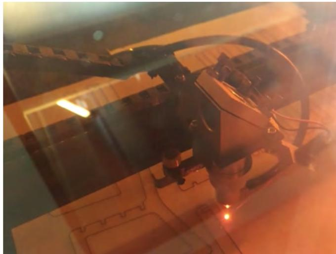
**Figura 05** - Protótipo da Cadeira SSV feitas na máquina de corte a laser.
