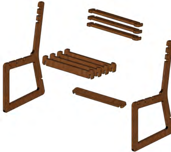
Figura 04 - Peças Cadeira SSV feitas a partir de modelagem 3D.
