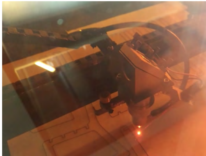
Figura 05 - Protótipo da Cadeira SSV feitas na máquina de corte a laser.
