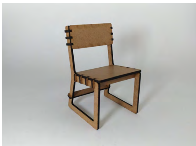
Figura 07 - Protótipo da Cadeira SSV feitas na máquina de corte a laser.
