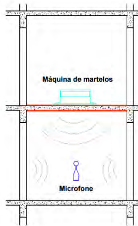
Figura 10: Mostra em corte o posicionamento dos equipamentos para medir o L'nTw.
