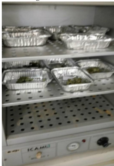
Figura 3: Método de secagem do material em estufa – FAL-UnB
