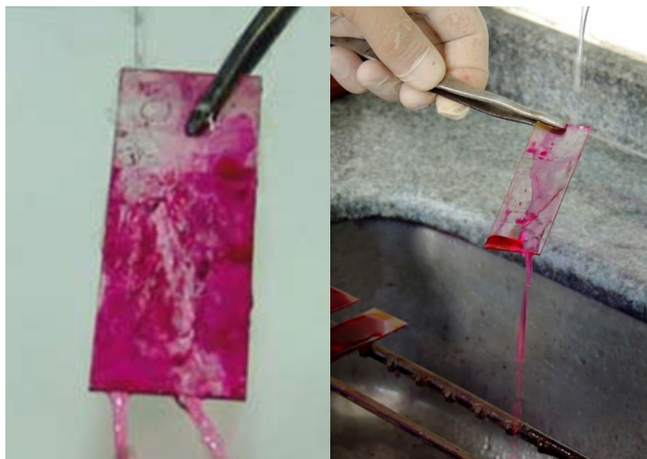
Figura 14 – Lavagem da fucsina em água corrente
