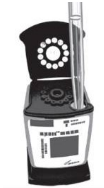
Figura 25 – Esquematização da adição da amostra no cartucho de TRM-TB
