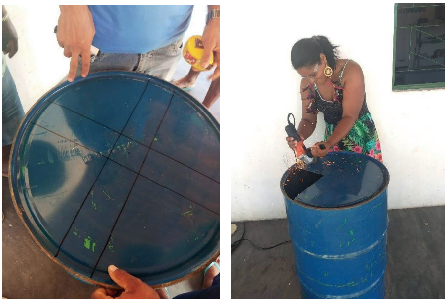
Figura 8. Membro da comunidade Pankará realizando o corte em formato de X.
