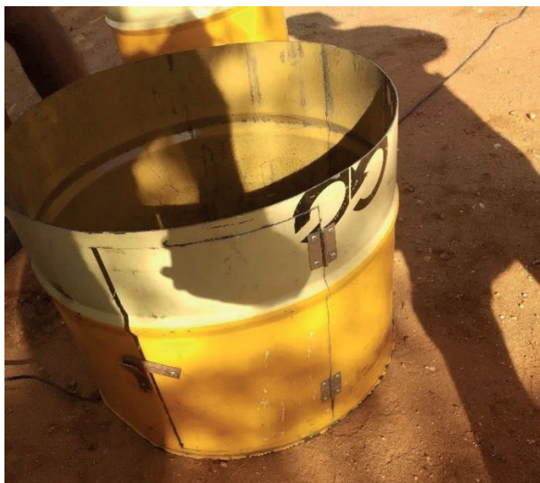
Figura 7. Porta com dobradiças e fechadura finalizada.
