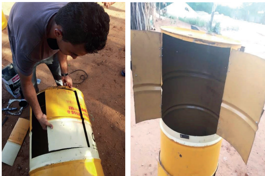
Figura 10. Corte e fixação da porta.
