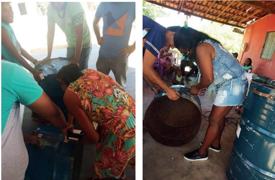
Figura 6. Representantes das Comunidades Pankará e Poços dos Cavalos realizando a fixação das dobradiças à base.
