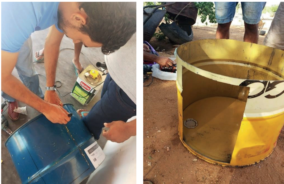
Figura 4. Marcação e abertura de porta da base do defumador.
